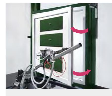
Zkušební stolice okna pro zatížení dobou používání
