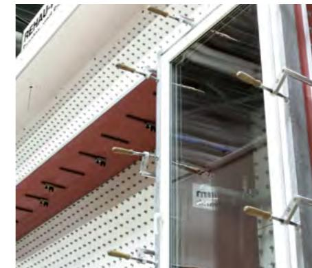
Testovací zařízení pro zatížení tlakem větru
